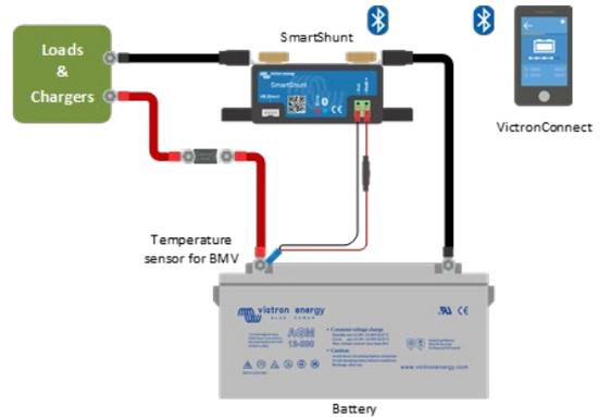
Mesure de la température de batterie
